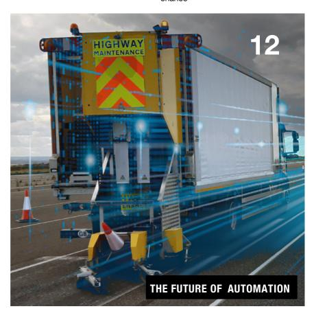
HIGHWAY CARE'S AUTOMATED CONE LAYING MACHINE COMPLETES TRIALS
